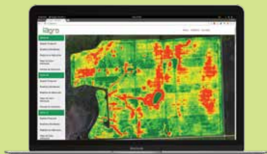
Versão web (dashboard) do sistema de monitoramento com ferramentas de análise mais avançadas. Mapas de calor dos níveis de infestação. Acompanhamento de aplicações de defensivos
