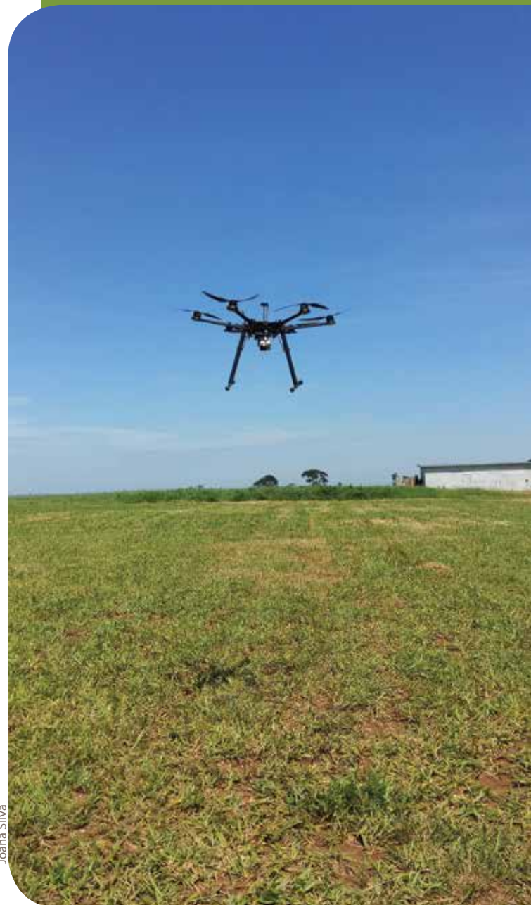
Drone hexacóptero carrega mais peso, bateria e câmera
